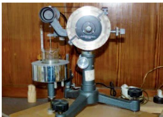
Apparato per la determinazione della tensione superficiale
