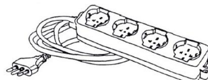
Spine di tipo tedesco (Schuko) possono essere inserite in prese di tipo italiano solo tramite un adattatore che trasferisce il collegamento di terra effettuato mediante le lamine laterali ad uno spinotto centrale. È assolutamente vietato l'inserimento a forza delle spine Schuko nelle prese di tipo italiano. Infatti, in tale caso dal collegamento verrebbe esclusa la messa a terra.
