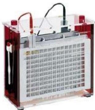
Uno dei potenziale pericoli che si corrono utilizzando apparecchiature per elettroforesi è l'elettrocuzione causata da contatti accidentali con parti in tensione. Il pericolo esiste sia operando ad alto voltaggio, come durante la sequenziazione del DNA, o a basso voltaggio, come nell'elettroforesi con gel di agarosio (100 volts a 25 mA). Un corretto operare durante le operazioni di elettroforesi prevede:
