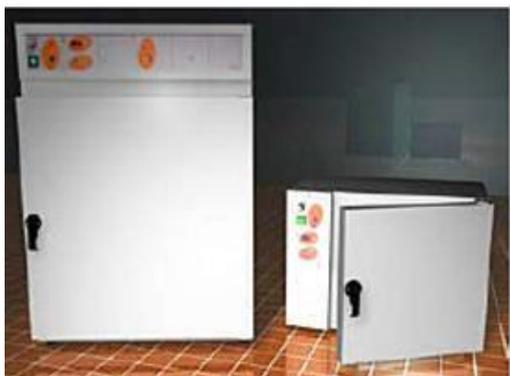
Normalmente le stufe sono utilizzate in laboratorio per rimuovere l'acqua o altri solventi dai campioni o per asciugare la vetreria.
