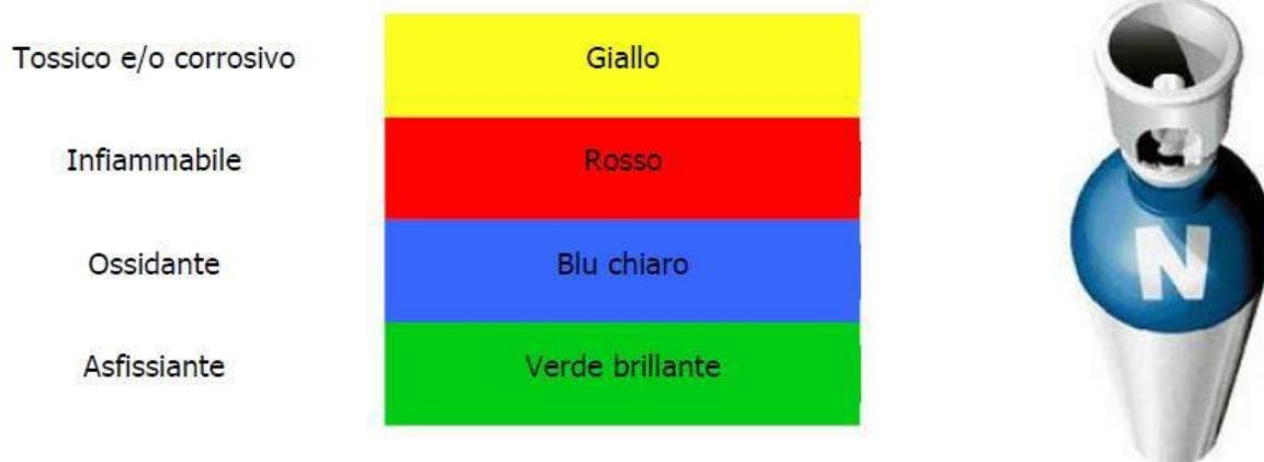
Figura 17.3 - Natura del pericolo del gas in relazione al colore dell'ogiva della bombola
